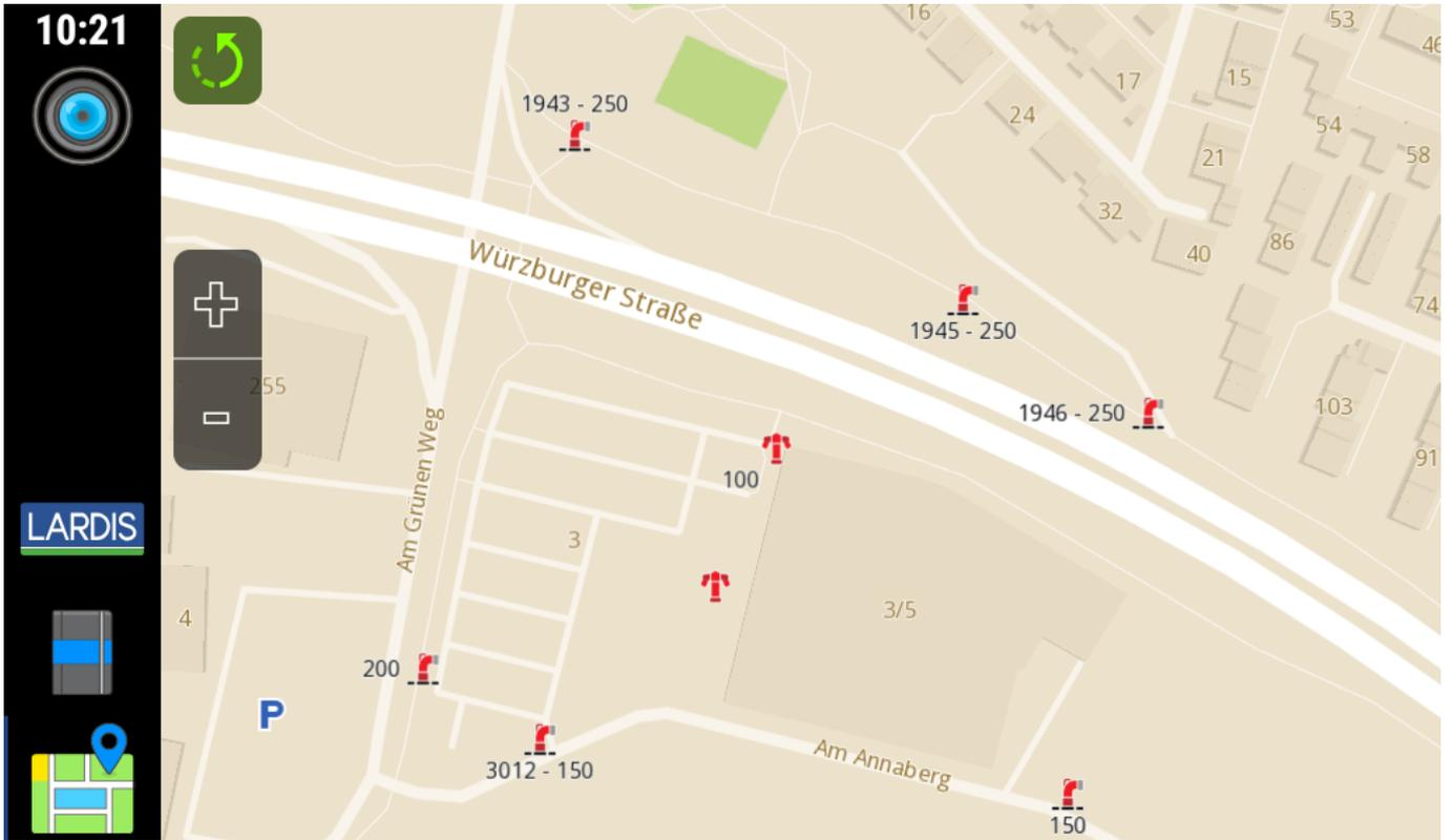
In OpenStreetMap können diese Informationen wie auf dem Screenshot ersichtlich hinterlegt werden. Der Durchmesser wird als "fire\_hydrant:diameter" in Millimeter angegeben. Die Referenz (Schlüsselnummer, falls vorhanden) ist am Hydrantenschild abzulesen und als numerischer Wert bei "ref" einzutragen. Weitere Informationen hierzu finden Sie in der [OSM-Wiki](#).
