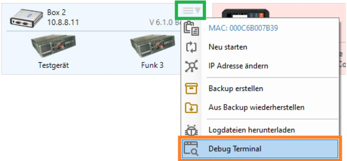
Im geöffneten Terminal-Fenster muss nun vom gewünschten Gerät / Port das Log-Level erhöht werden, um möglichst alle Details zu erhalten. Drücken Sie die Ziffer bzw. den Buchstaben (orangene Markierung) vor dem Port / Gerät mehrfach auf der Tastatur, bis "D5" (grüne Markierung) angezeigt wird.
